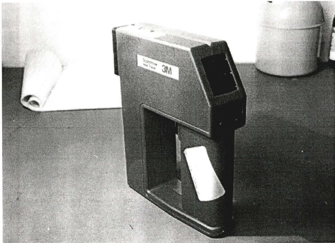
รูปที่ 1 เครื่องวัดอุณหภูมิด้วยการแผ่รังสี 3M Heat Tracer Radiation Thermometer
