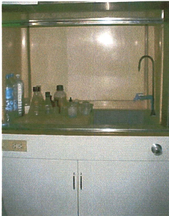
รูปที่ 3.1 ตู้ทำความสะอาดแผ่นสารกึ่งตัวนำ
