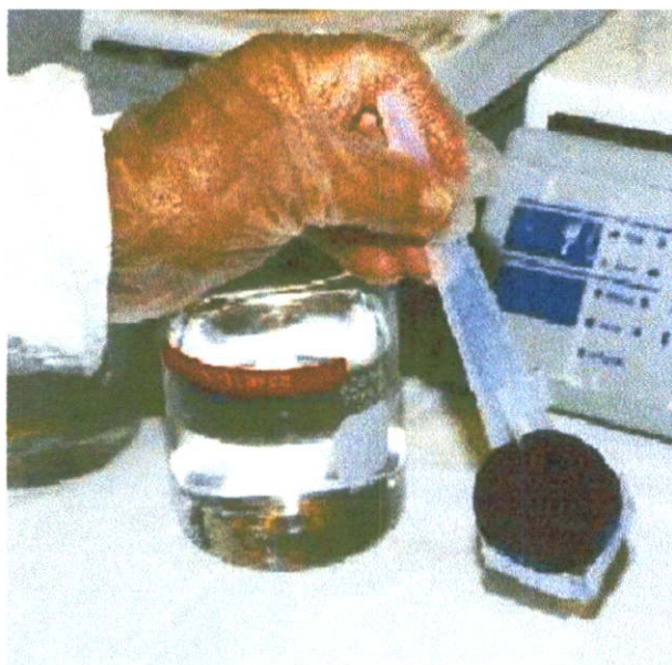
รูปที่ 3.9 แผ่นสารกึ่งตัวนำแกลเลียมอาร์เซไนด์โพสไฟต์
