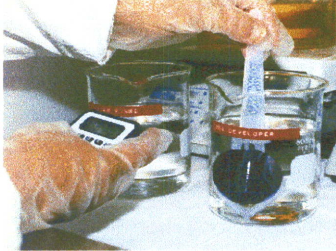
รูปที่ 13.17 การกำจัดฟิล์มไวแสงส่วนที่โดนแสง
