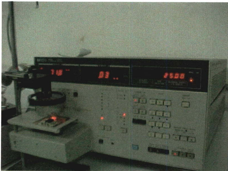
รูปที่ 3.34 ระบบการวัดสมบัติค่าความจุ-แรงดัน
