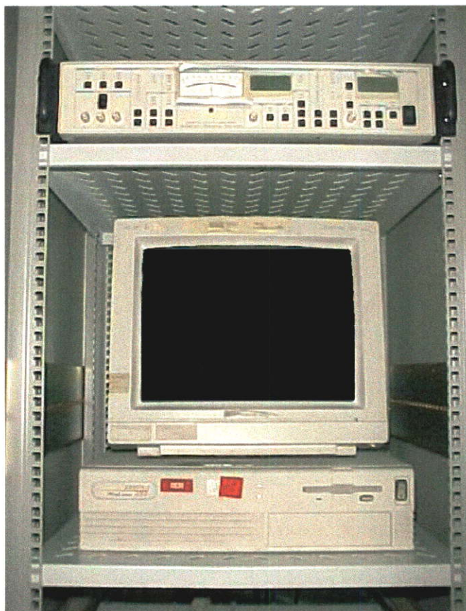
รูปที่ 3.27 คอมพิวเตอร์สำหรับควบคุมเครื่องขยายสัญญาณแบบล็อกอิน
