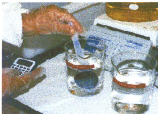
รูปที่ 3.13 วิธีทำความสะอาดแผ่นสารกึ่งตัวนำ
