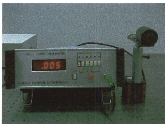
รูปที่ 3.24 เครื่องวัดกำลังแสงของเลเซอร์
