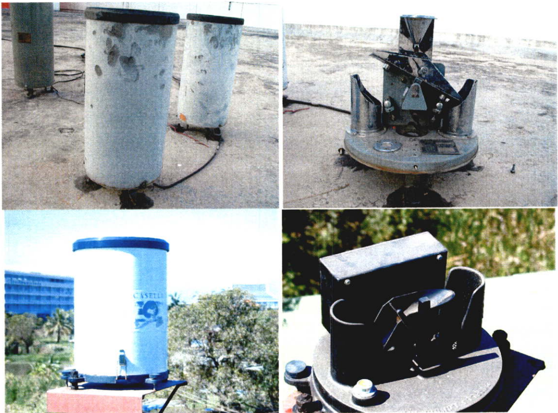
รูปที่ 3.7 อุปกรณ์วัดปริมาณน้ำฝนแบบ Tipping Bucket ที่ติดตั้งที่งานสาขอากาศ และที่ระยะประมาณ 2 กม. ในแนวแพร์คลีน และโครงสร้างภายในอุปกรณ์วัดปริมาณน้ำฝน
