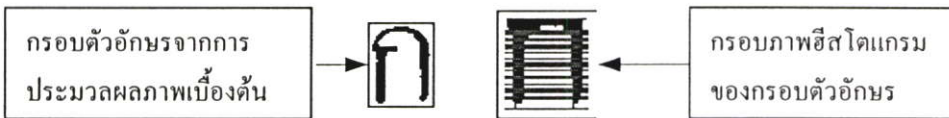
รูปที่ 3.5 แสดงโครงสร้างลักษณะเด่นของตัวอักษร 2 ขา ที่ได้จากค่าฮิสโตแกรมของกรอบตัวอักษร
