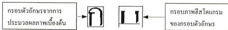
รูปที่ 3.8 แสดงโครงสร้างลักษณะเด่นของขอบล่างเปิดที่ได้จากค่าฮิสโตแกรมของกรอบตัวอักษร
