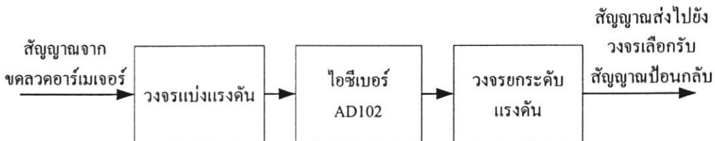
รูปที่ 5.9 การวัดค่ากระแสไฟฟ้าที่ไหลเข้าขดลวดอาร์เมเจอร์
