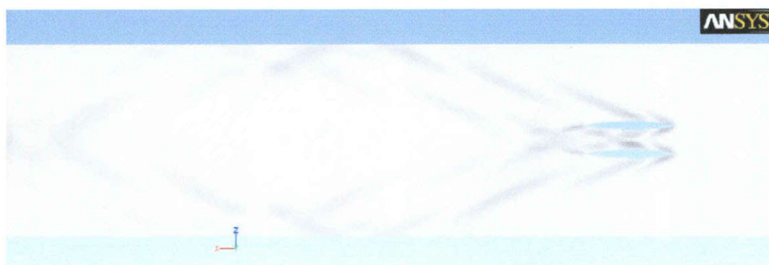
รูปที่ 4.19 รูปแบบคลื่น (Wave Pattern) ที่เกิดจากเรือห้องคู่ Model 3 ที่ F_n เท่ากับ 0.6
