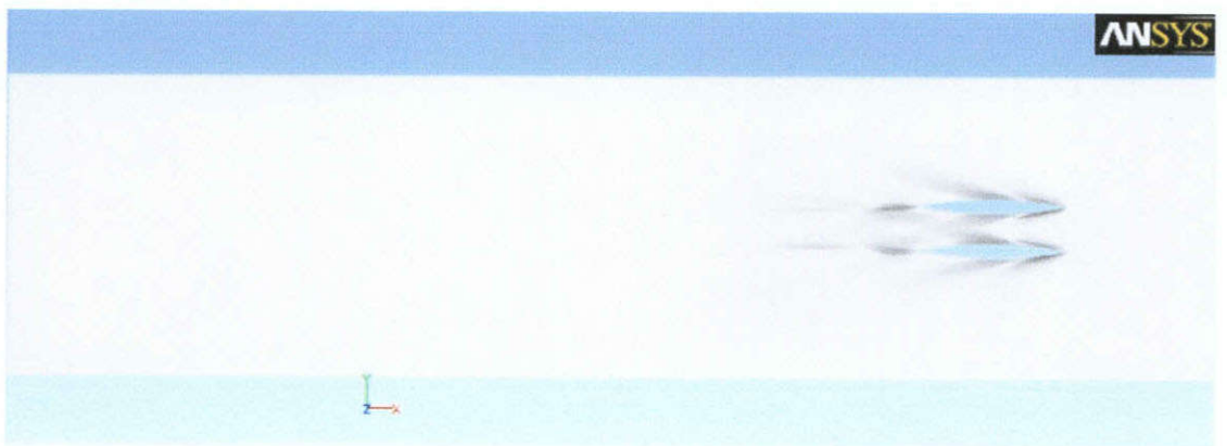
รูปที่ 4.26 รูปแบบคลื่น (Wave Pattern) ที่เกิดจากเรือท้องคู่ Model 4 ที่ F_n เท่ากับ 0.7
