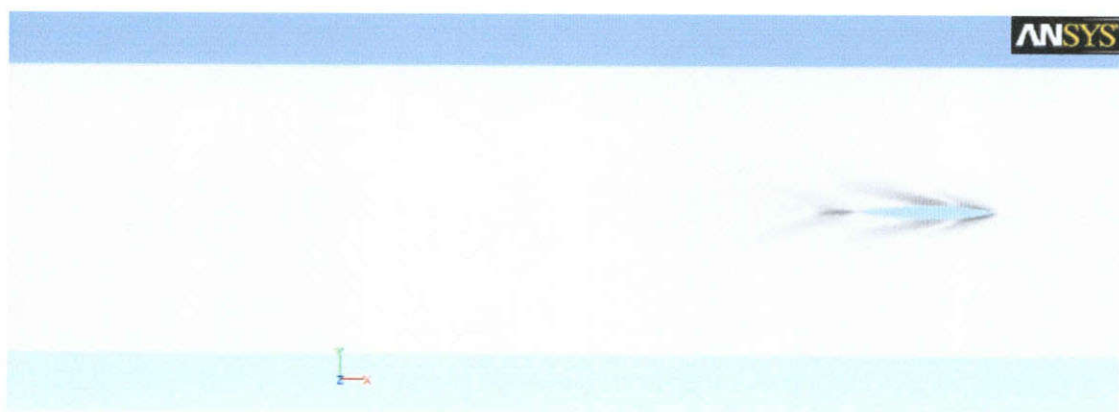
รูปที่ 4.8 รูปแบบคลื่น (Wave Pattern) ที่เกิดจากเรือท้องเดี่ยวที่ F_n เท่ากับ 0.7
