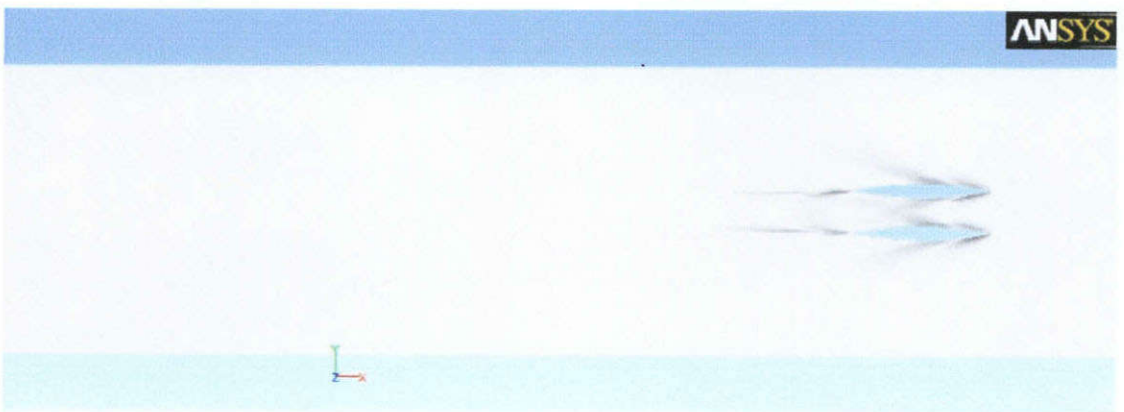
รูปที่ 4.25 รูปแบบคลื่น (Wave Pattern) ที่เกิดจากเรือท้องคู่ Model 4 ที่ F_n เท่ากับ 0.6
