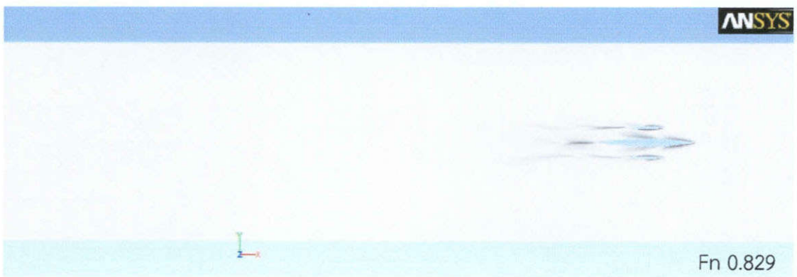
รูปที่ 4.44 รูปแบบคลื่น (Wave Pattern) Model 6 ในช่วง Fn เท่ากับ 0.772 – 0.829
