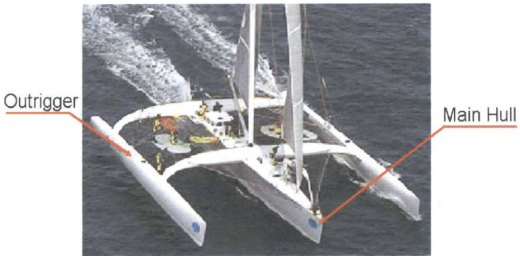
รูปที่ 4.35 แสดงตำแหน่งของตัวเรือหลัก (Main hull) และตัวเรือด้านข้าง (Outrigger) [3]
