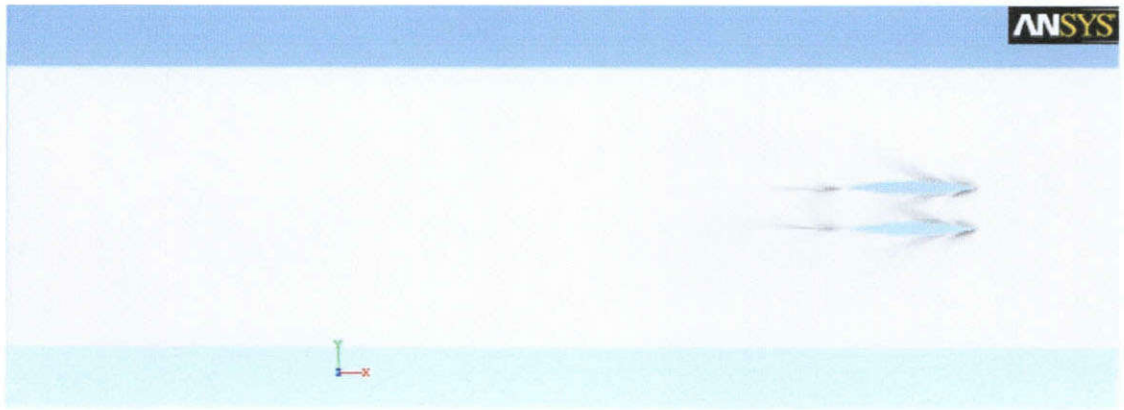
รูปที่ 4.24 รูปแบบคลื่น (Wave Pattern) ที่เกิดจากเรือท้องคู่ Model 4 ที่ F_n เท่ากับ 0.5
