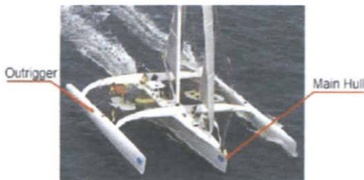
รูปที่ 1 เรือไตรมาราน แสดงตำแหน่งของตัวเรือหลัก (Main hull) และตัวเรือด้านข้าง (Outtrigger) [2]
