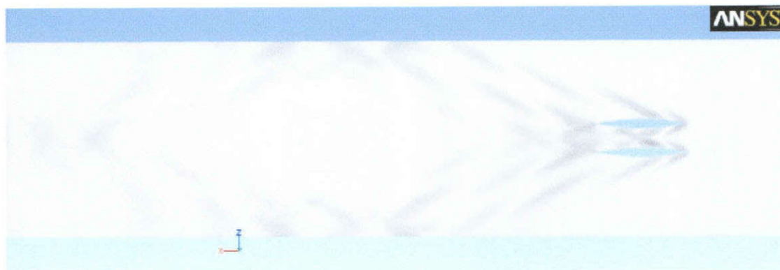
รูปที่ 4.18 รูปแบบคลื่น (Wave Pattern) ที่เกิดจากเรือห้องคู่ Model 3 ที่ F_n เท่ากับ 0.5
