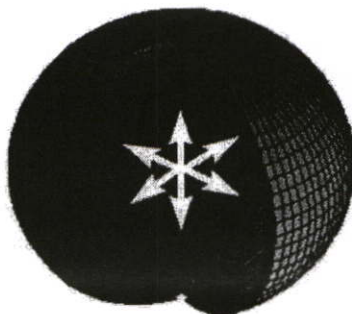
รูปที่ 3.8 การกระจายแบบ Isotropic เป็นต้นเหตุของการสูญเสียในอวกาศว่าง
