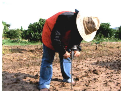
รูปที่ 5.8 การวัดความต้านทานการแทงทะลุดิน (Cone Index)
