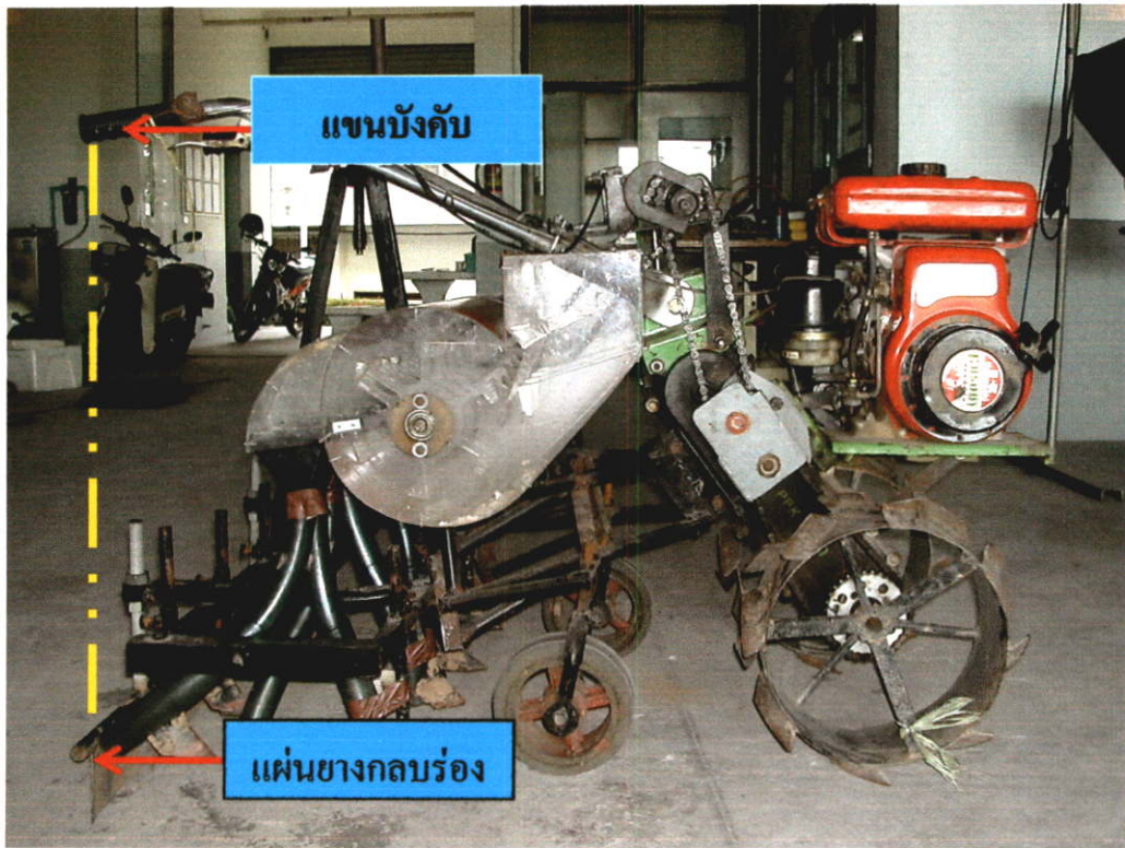
รูปที่ 4.7 ตำแหน่งของแกนบังคับและแผ่นยางกลบร่อง
