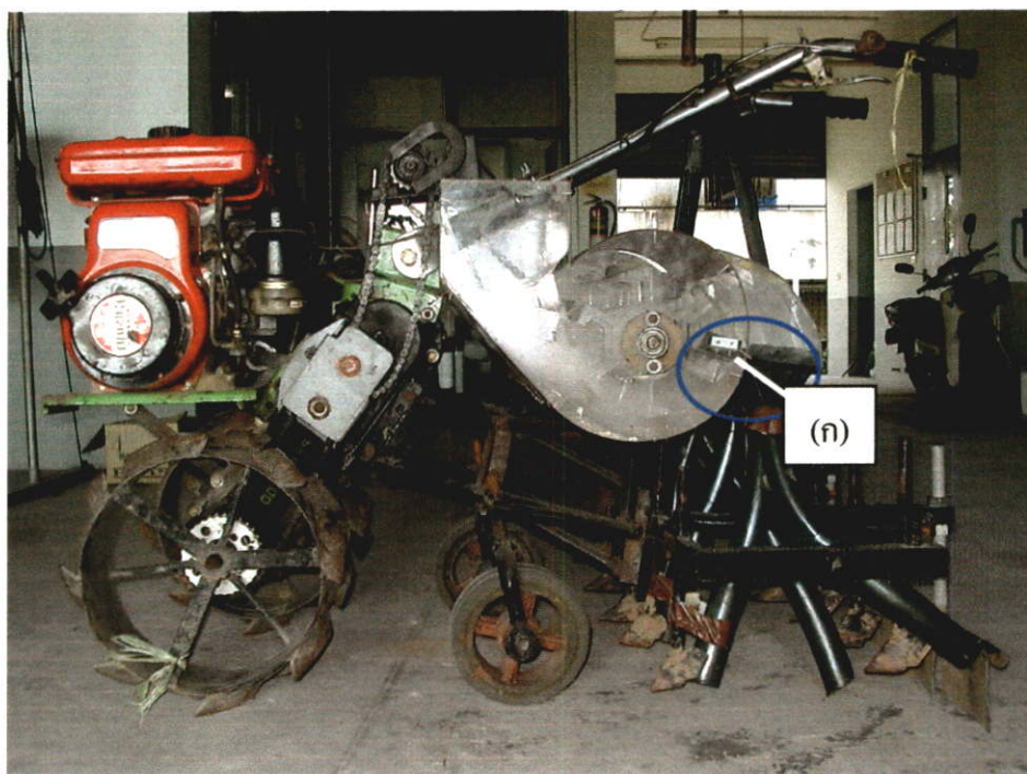
รูปที่ 6.1 รูปด้านข้างของเครื่องแสดงขอบถังด้านล่างที่เกิดปัญหา (ก)
