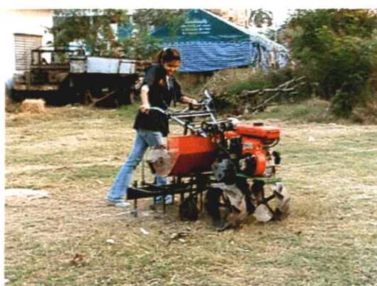
รูปที่ 5.26 แสดงการทดสอบทางตรงและขณะเลี้ยว
