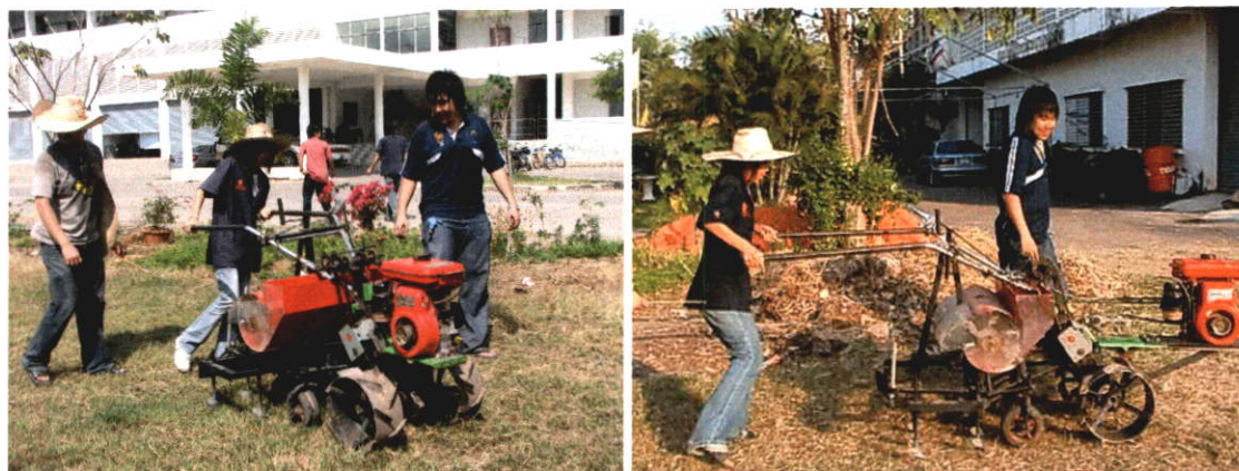
รูปที่ 5.28 แสดงการทดสอบเครื่องเมื่อปรับระยะเครื่องยนต์และความยาวแขน
