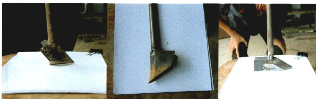
(ก)ตัวเปิดร่องแบบรองเท้า(shoe type) (ข)ตัวเปิดร่องแบบจอบ (hoe type) (ค)ตัวเปิดร่องแบบพลั่ว (shovel type)
