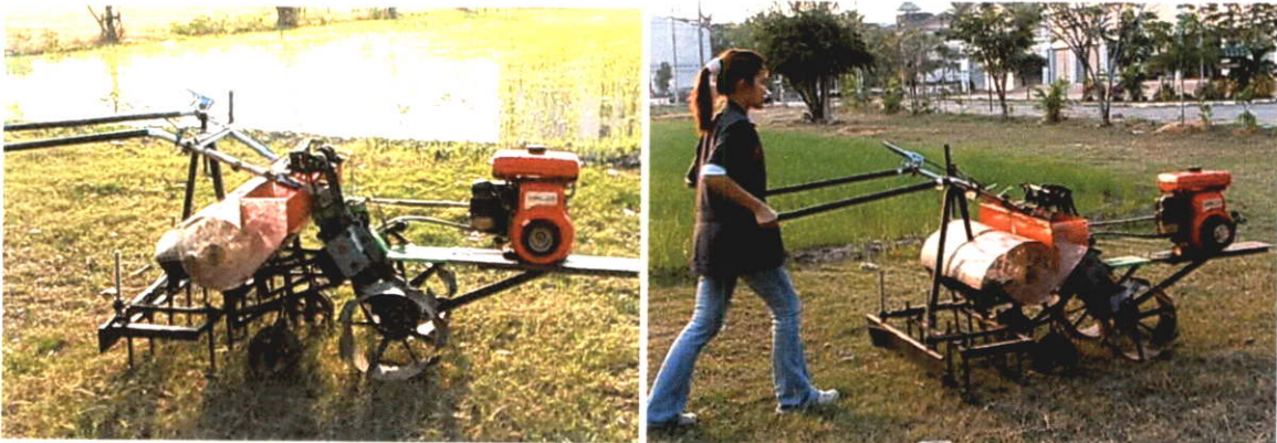
รูปที่ 5.29 แสดงลักษณะเครื่องปลูกกระเทียมที่ปรับปรุงแล้ว
