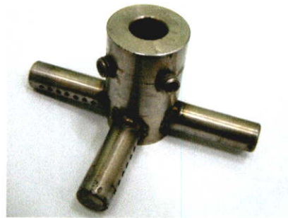
รูปที่ 2. แสดงลักษณะรูปทรงของใบพัดแบบที่ 1.
