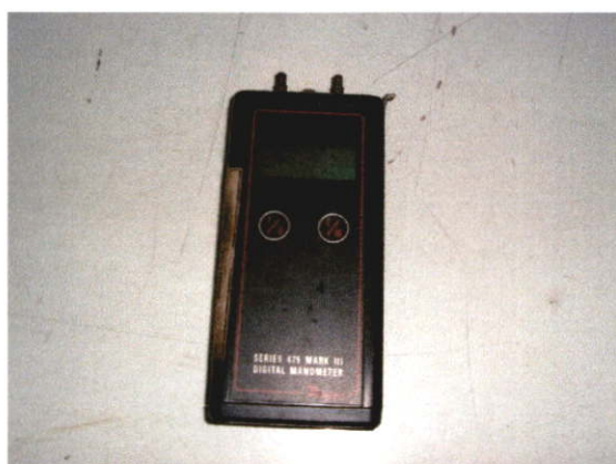
รูปที่ 4.12 เครื่องมือวัดผลต่างความดันแบบดิจิตอล
