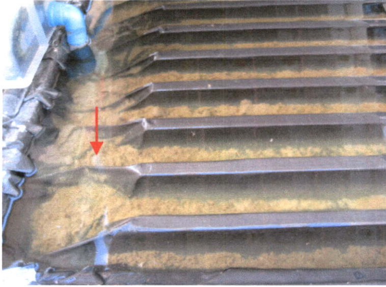
ภาพที่ 4.16 ลักษณะของตะกอนในรางบนโต๊ะปลูกในระบบ DRFT-Fish
