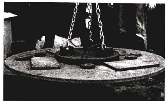
รูปที่ 8 การทดสอบยกแผ่นเหล็กที่น้ำหนัก 250kg
