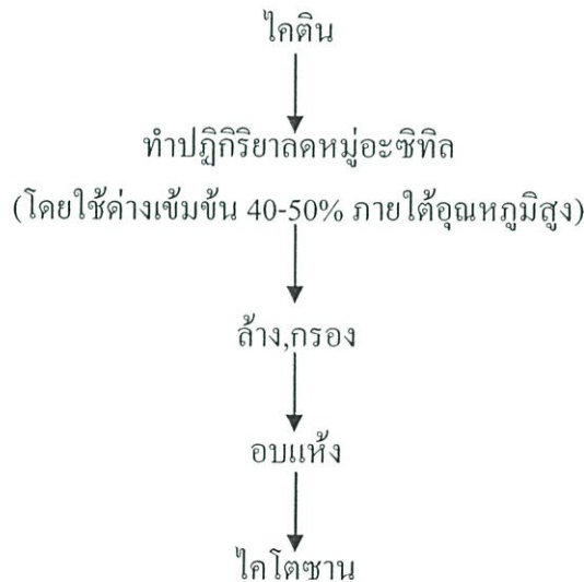
รูปที่ 2.4 ขั้นตอนทั่วไปของการผลิตไคโตซาน (เขาวภา, 2534)
