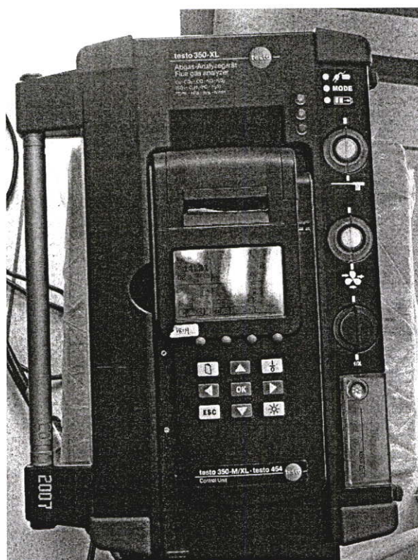
รูปที่ ข.8 เครื่องวัดก๊าซเสีย (Gas Analyzer)
