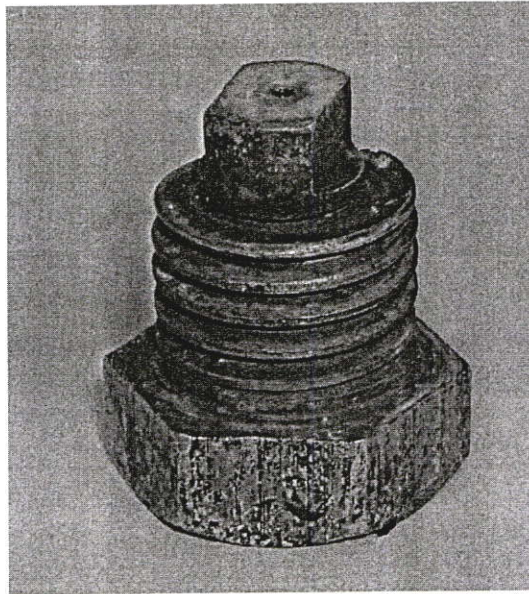
รูปที่ ข.1 หัวฉีดเชื้อเพลิงและอากาศ
