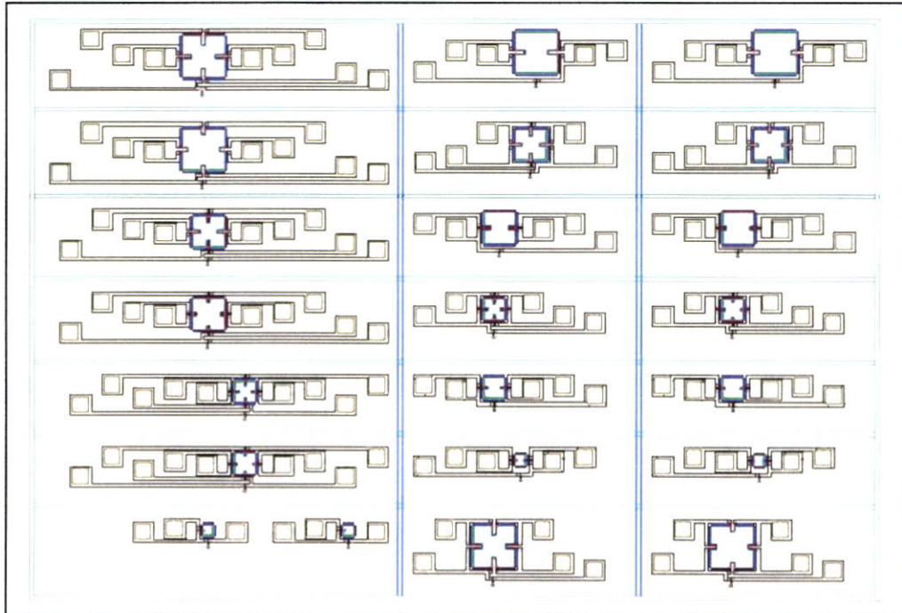
รูปที่ 4.9 ภาพรวมของทรานสดิวเซอร์ความดันแบบเปียโซรีซิสทีฟที่ออกแบบด้วย L-Edit
