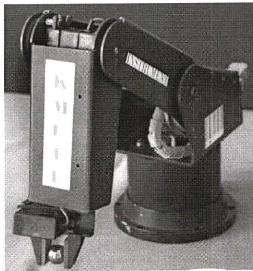
รูปที่ 5.6 แสดงการทำงานของแขนกลเมื่อทำการหยิบลูกเหล็ก
