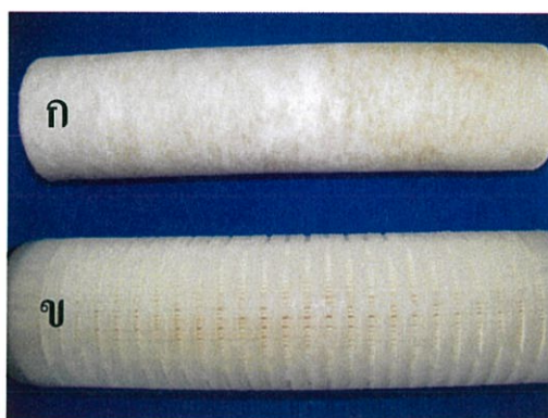
รูปที่ 3.3 แท่งกรองไมโครที่ใช้ในการบำบัดน้ำเบื้องต้น (ก) 5 \mu\text{m} (ข) 0.40 \mu\text{m}
