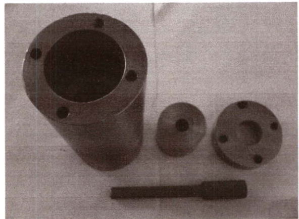
รูปที่ 4 ชุดอุปกรณ์ที่ใช้ในการทดลอง Die holder, container, ring holder และ punch
