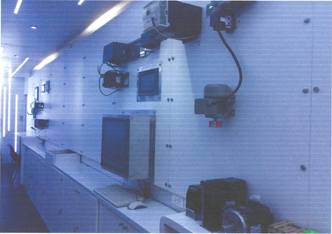
รูปที่ 4.21 แผงสาธิตฝังประตูหลังจากติดตั้งอุปกรณ์และเดินสายไฟเข้าอุปกรณ์
