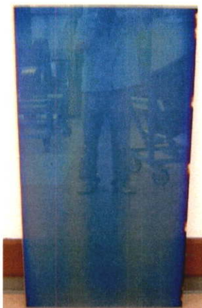
รูปที่ 4.7 ชั้นตัวนำโปร่งแสง ZnO ที่ทำการสร้างลงบนแผ่นกระจก
