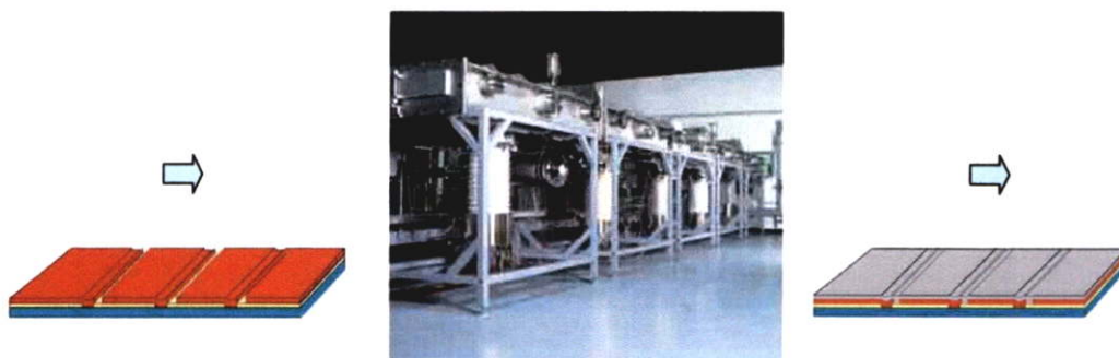
รูปที่ 3.5 (e) ขั้นตอนที่ 5 การสร้างชั้นตัวนำ (Sputtering)
