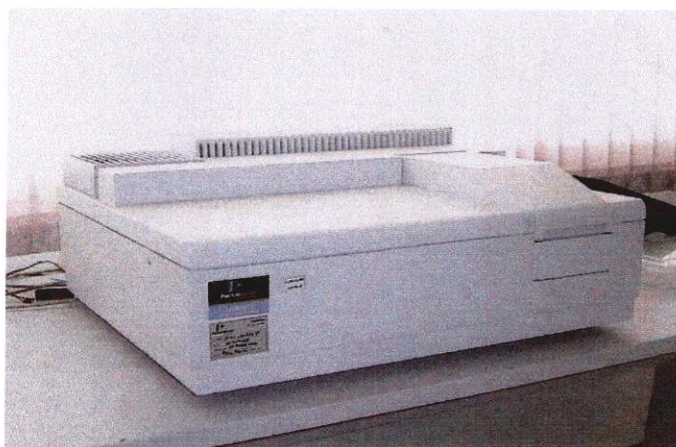
รูปที่ ข-2 เครื่องวัดสัมประสิทธิ์การดูดกลืนแสง (UV-VIS Spectrometer)
