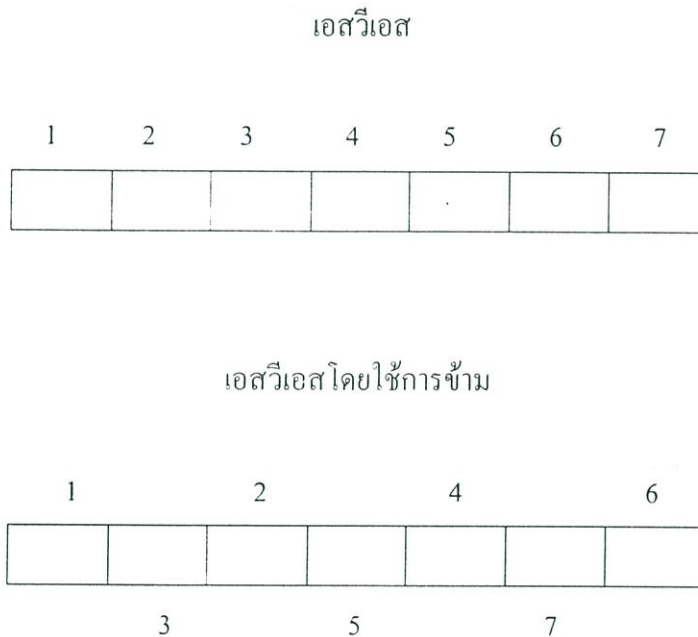
รูปที่ 3.3 ลำดับการค้นหาในลิสต์ข้อมูลของเอสวีเอส และเอสวีเอสแบบข้าม 2 ตำแหน่ง
