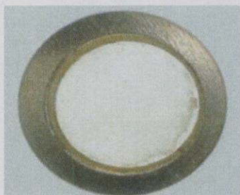
รูปที่ 2.3 แผ่น Diaphragm ของลำโพงแบบเพียโซ ที่มีโครงสร้างตรงกลางเป็นฉนวนคอร์ตซ์
