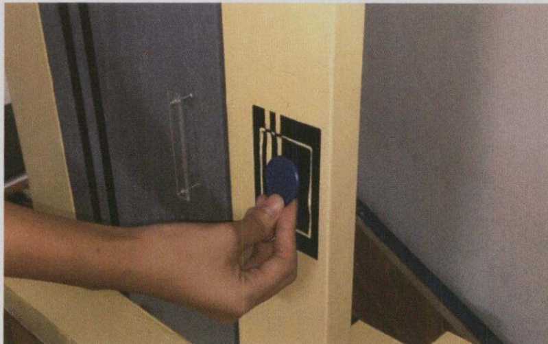
รูปที่ ก.10 ทดสอบปลดล็อคประตูด้วยอาร์เอฟไอดีแท็ก
