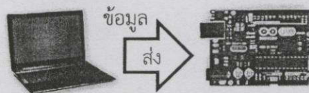
รูปที่ 3.10 คอมพิวเตอร์ส่งข้อมูลไปยัง Arduino UNO R3
