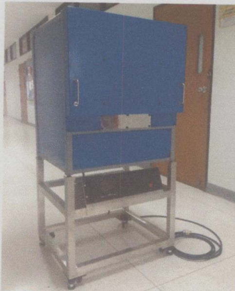
รูปที่ 3. 14 เตาอบความร้อนสูงพร้อมระบบควบคุมอุณหภูมิ
