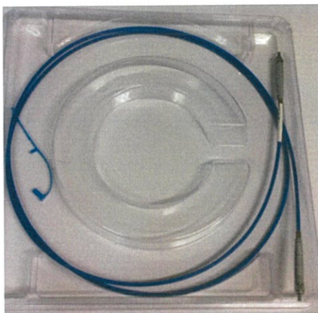
รูปที่ 3.3 สายใยแก้วนำแสงสำหรับนำส่งแสงจากแหล่งกำเนิดแสงไปยังฟิล์มบาง
