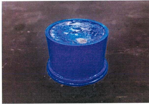
รูปที่ 5.6 แม่พิมพ์ที่ได้วางชิ้นงานและเทอร์ซีนเหลวลงไปภายใน
