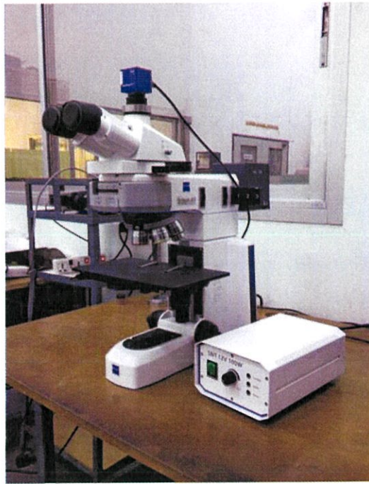
รูปที่ 4.1 กล้องจุลทรรศน์แบบใช้แสง (LOM)
