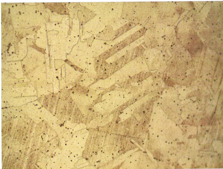
รูปที่ 6.8 เหล็กกล้าไร้สนิมชนิด 316L อบด้วยความร้อนที่อุณหภูมิ 850 องศาเซลเซียส 6 ชั่วโมง
