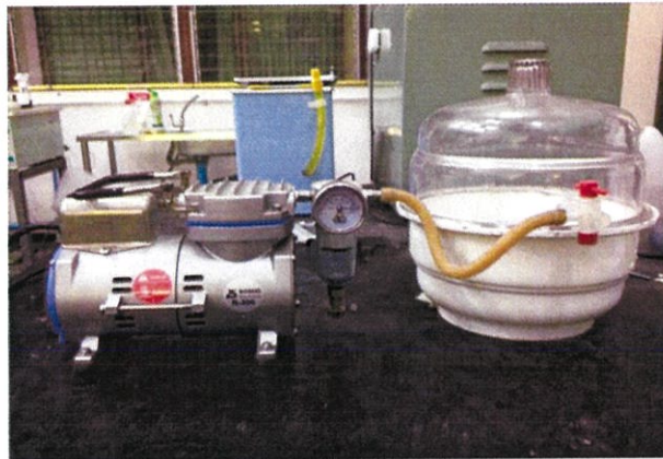
รูปที่ 4.7 เครื่องปั๊มดูดสุญญากาศ (vacuum pump)
