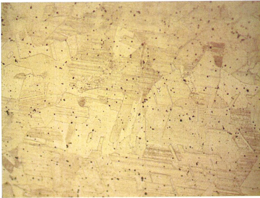
รูปที่ 6.3 เหล็กกล้าไร้สนิมชนิด 316L อบด้วยความร้อนที่อุณหภูมิ 725 องศาเซลเซียส 2 ชั่วโมง
