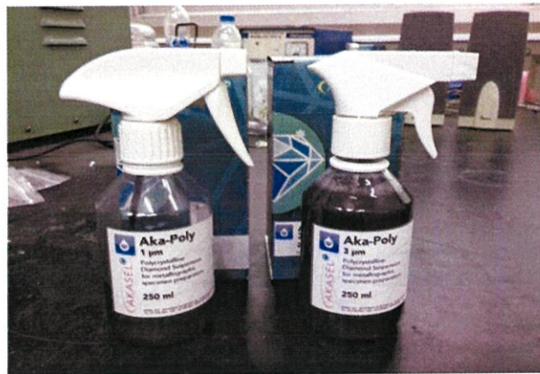
รูปที่ 5.9 สารละลายผสมผงขัดเพชร (polycrystalline diamond suspension)
