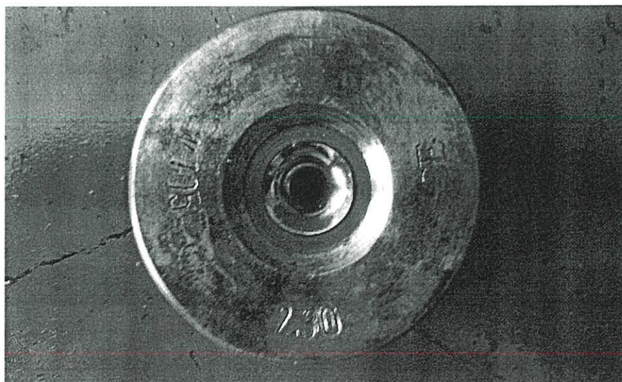
รูปที่ 3.21 แม่พิมพ์ดึงลวดตามมาตรฐาน W103 ไม่เคลือบผิว
