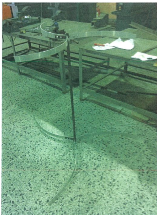
รูปที่ 3.20 แสดงลักษณะของการประกอบโครงอลูมิเนียมกับเพลากันหมุน
