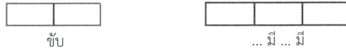
รูปที่ 2.21 แสดงสัญลักษณ์ของความสัมพันธ์ระหว่างอ็อบเจกต์
