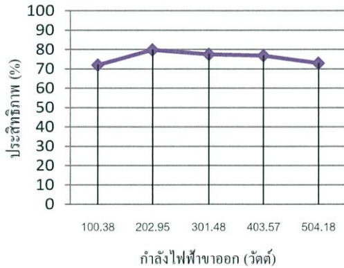
รูปที่ 17 ความสัมพันธ์ระหว่างกำลังไฟฟ้าออก กับ ประสิทธิภาพ ที่ ระยะห่าง 4 เซนติเมตร
