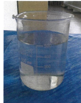
ภาพที่ ก-2 ลักษณะน้ำเสียจากกระบวนการผลิตอุตสาหกรรมอาหาร ที่ผ่านการบำบัดด้วยไทเทเนียมไดออกไซด์
