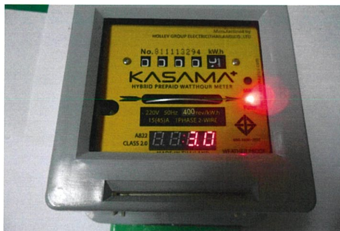
รูปที่ 4.22 รูปภาพแสดงถึงการกะพริบของไฟเมื่อ จำนวนไฟมีน้อย
