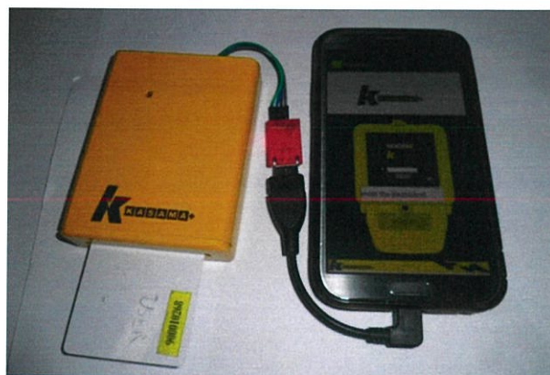
รูปที่ 4.6 รูปแสดงว่าเมื่อมีการเสียบเครื่องอ่านการ์ดกับมือถือแล้วโปรแกรมจะเปิดอัตโนมัติ
