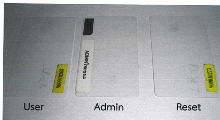
รูปที่ 4.3 สมาร์ทการ์ด สำหรับใช้ในการเติมหน่วยไฟฟ้าเข้าในมิเตอร์
