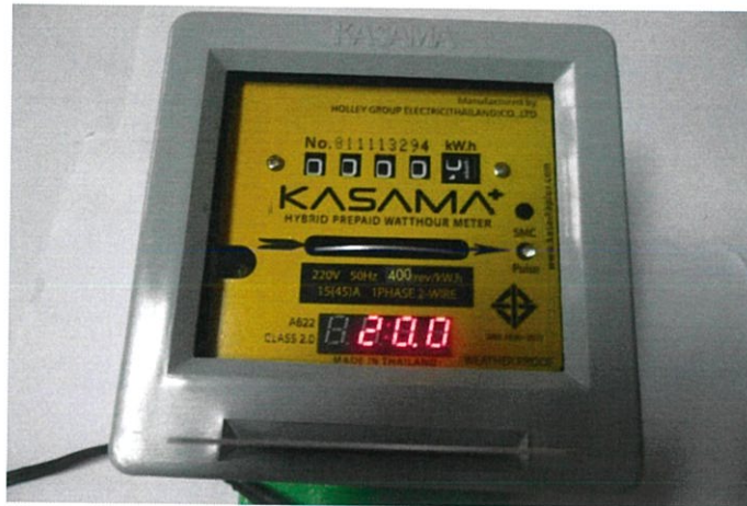
รูปที่ 4.19 รูปแสดงการเติมหน่วยไฟฟ้าเข้าไปในตัวมิเตอร์ไฟฟ้า
