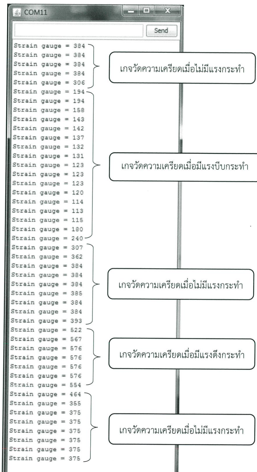
รูปที่ 4.36 การประมวลค่าความเครียดโดยไมโครคอนโทรลเลอร์
