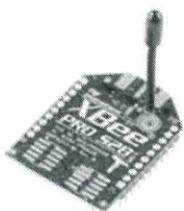
รูปที่ 3.33 เอ็กซ์บี รุ่น XBee Pro 50mW Wire Antenna - Series 2 (ZB) [11]
