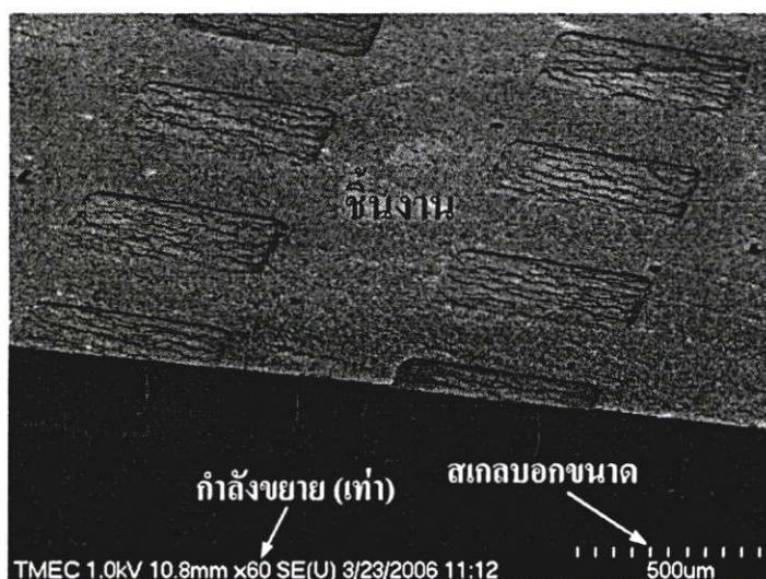
รูปที่ 2.8 ลักษณะของภาพ SEM ของผิวหน้าชิ้นงาน
