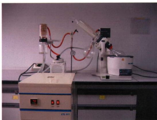
ระเหยตัวทำละลายออกโดยเครื่องระเหยแบบหมุน ภายใต้สุญญากาศ (Rotary evaporator) อุณหภูมิ 45 องศาเซลเซียส
