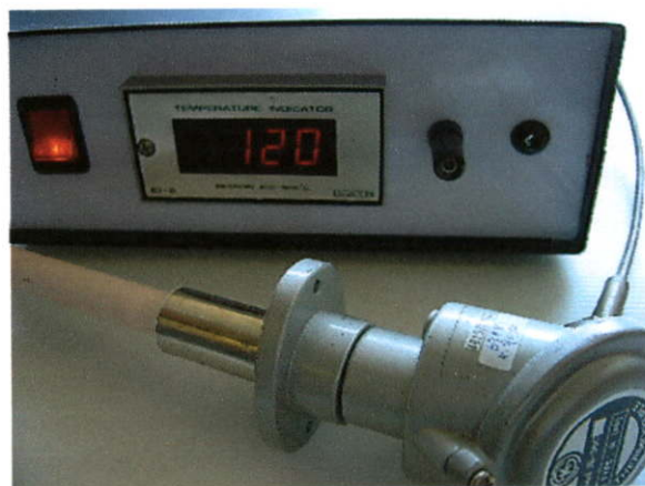
รูปที่ 4.17 Thermocouple Type R และ Temperature Switches & Display
