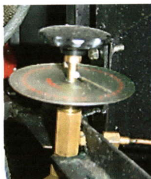
รูปที่ 4.13 ลักษณะของวาล์วเข็มที่ใช้ปรับอัตราการไหลน้ำมัน
