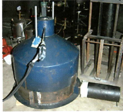
รูปที่ 4.28 ลักษณะการวัดปริมาณก๊าซเสียของหัวเตาหุงต้มรุ่น KB 5
