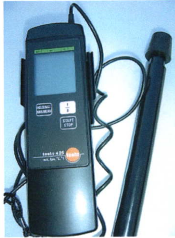
รูปที่ 4.18 อุปกรณ์วัดอัตราการไหลของอากาศที่ใช้ในการเผาไหม้
