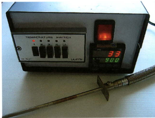
รูปที่ 4.16 Thermocouple Type k และ Temperature Switches & Display
