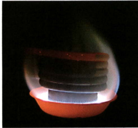
รูปที่ ค.8 ภายหลังจากอุดน้ำมันระเหยเป็นไอและลูกใหม่ได้ด้วยตัวเองที่ RVD = 70 mm
