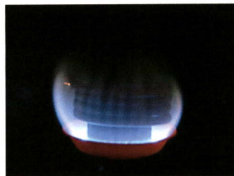
รูปที่ ค.10 ภายหลังจากอุดน้ำมันระเหยเป็นไอและลูกใหม่ได้ด้วยตัวเองที่ RVD = 90 mm
