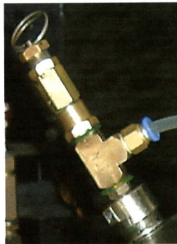
รูปที่ 4.11 วาล์วควบคุมความดันภายในถังน้ำมัน
