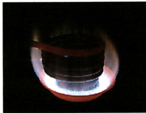
รูปที่ ค.9 ภายหลังจากอุดน้ำมันระเหยเป็นไอและลูกใหม่ได้ด้วยตัวเองที่ RVD = 80 mm
