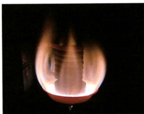
รูปที่ 1.6 ภายหลังจากการอุ่นเมื่อน้ำมันระเหยเป็นไอและลูกไหม้ได้ด้วยตัวเองที่ RVD = 50 mm
