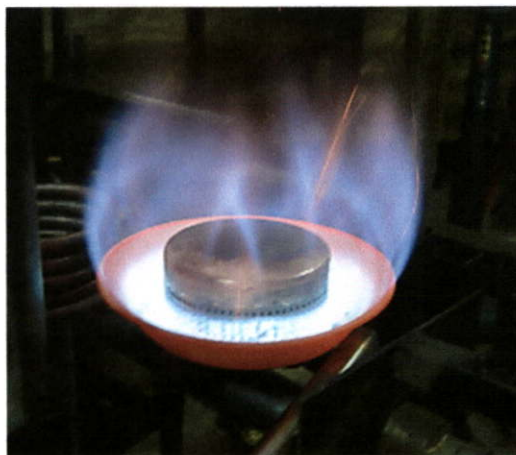
รูปที่ ค.11 ลักษณะของเปลวไฟจากหัวเผาแบบฉีดเชื้อเพลิงร่วมที่ใช้ LPG เป็นเชื้อเพลิง
