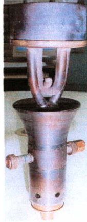
รูปที่ 2.1 ลักษณะของชุดหัวเผาน้ำมันพีซแบบ Non Premixed [2]
