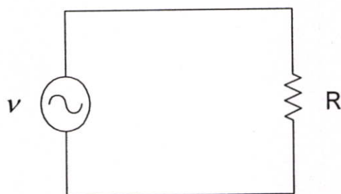
รูปที่ 2.8 วงจรไฟฟ้ากระแสสลับที่มีโหลดเป็นตัวต้านทาน
