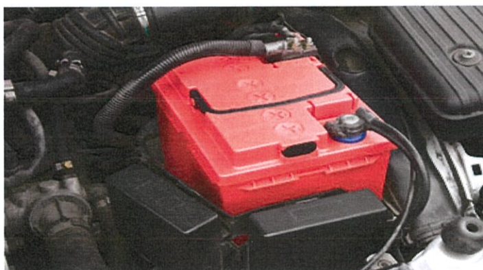
รูปที่ 2.4 ภาพแสดงตำแหน่งของแบตเตอรี่รถยนต์และลักษณะของแบตเตอรี่
