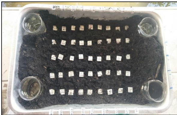
รูปที่ 3.1 การเตรียมทดสอบการย่อยสลายโดยฝังดิน
