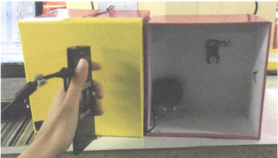
รูปที่ 4.9 แสดงการปิดไฟ โดยเอียงสมาร์ทโฟนลง
