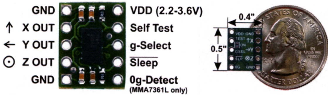
รูปที่ 3.2 ลักษณะและขนาดต่างๆของเซนเซอร์วัดความเร่ง MMA7361L
