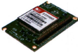
รูปที่ 3.9 โมดูลจีเอสเอ็ม ซิม900B
