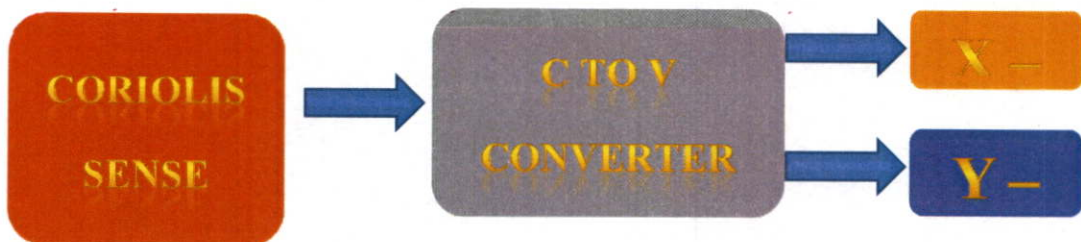
รูปที่ 2.6 หลักการทำงานภายในของเซ็นเซอร์ตรวจจับความเร็วเชิงมุม
