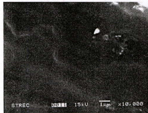
รูปที่ ๕ สัณฐานวิทยาจาก SEM ของวัสดุประกอบนาโน SBS/3% Organo-MMT
