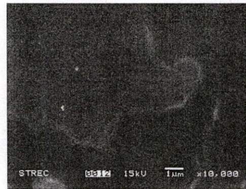
รูปที่ ๖ สัณฐานวิทยาจาก SEM ของวัสดุประกอบนาโน SBS/5% Organo-MMT
