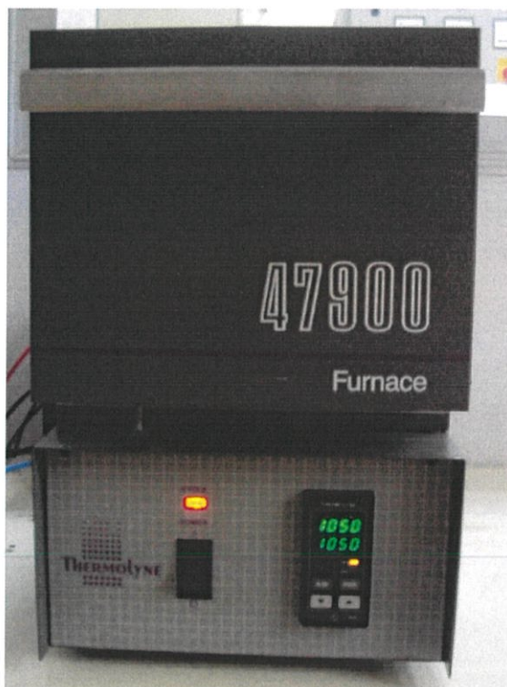
รูปที่ 12 เตาเผาใยห่อ Thermolyne มีขนาดกว้าง 13 ซม. ยาว 17 ซม. และสูง 10 ซม.
