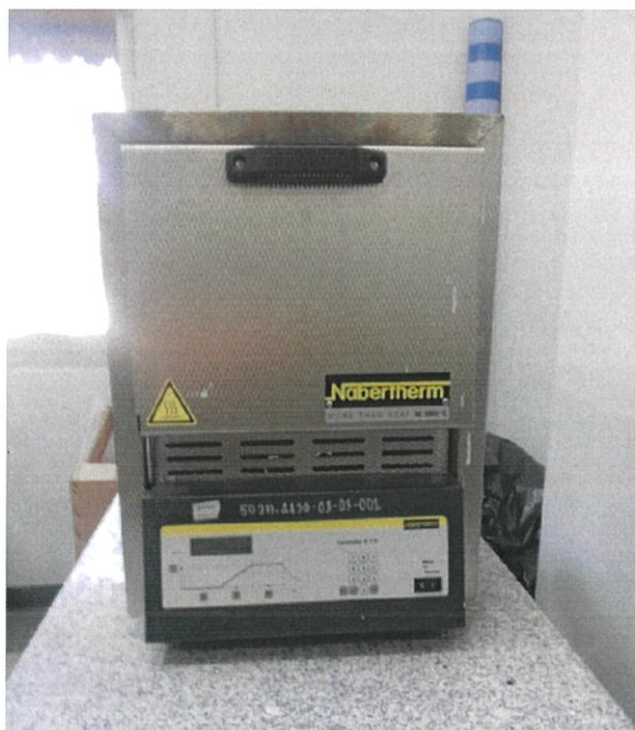
รูปที่ 13 เตาเผาใยห่อ Nabertherm มีอุณหภูมิสูงสุดที่ 2000 °C
