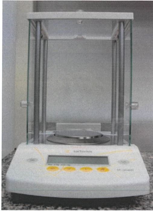
รูปที่ 8 เครื่องชั่งทศนิยม 4 ตำแหน่ง ยี่ห้อ Sartorius รุ่น AZ Series
