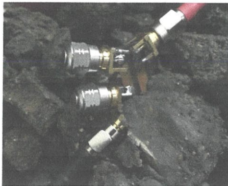
รูปที่ 3.15 การวัดค่า S_{21} ของสายอากาศ
