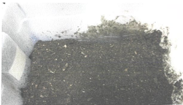
รูปที่ 3.17 การวัดในสภาพดินที่ผสมน้ำ 250 mL และทำการคลุกให้เข้ากัน
