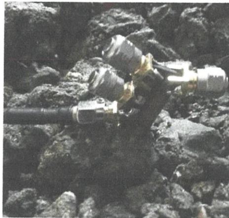
รูปที่ 3.14 การวัดค่าความสูญเสียย้อนกลับของสายอากาศโมนโพลตัวที่ 2
