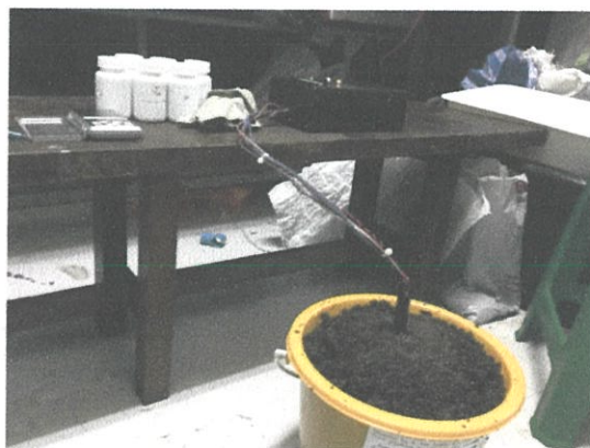
รูปที่ 3.19 การวัดในสภาพดินที่ผสมน้ำ 1,000mL และทำการคลุกให้เข้ากัน
