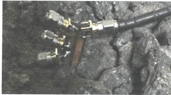
รูปที่ 3.13 การวัดค่าความสูญเสียย้อนกลับของสายอากาศโมนโพลตัวที่ 1
