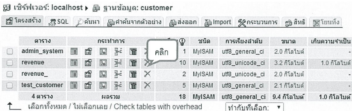
รูปที่ 3.49 หน้าต่างการลบตารางออกจากฐานข้อมูล
