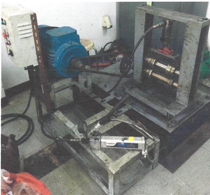
รูปที่ 3.2 ชุดทดลองการสึกหรอของล้อและรางรถไฟ
