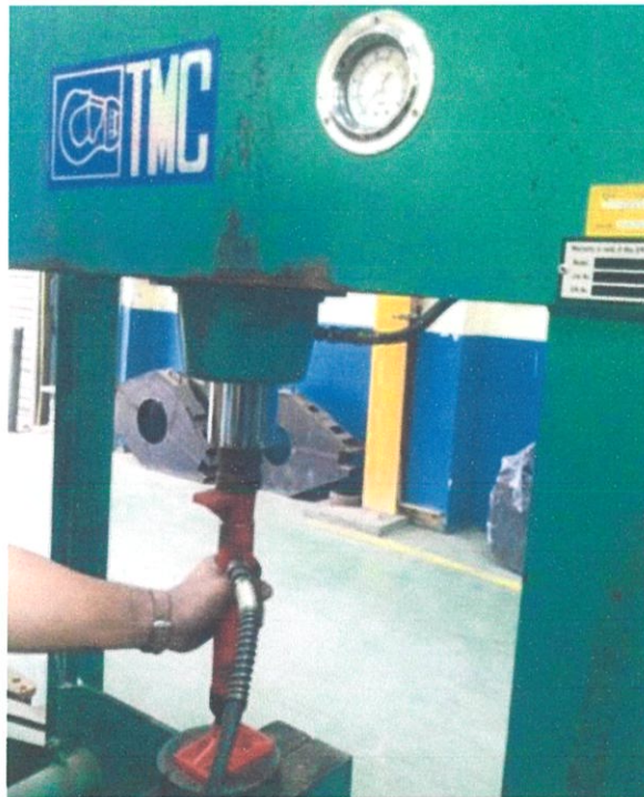
รูปที่ 4.1 การสอบเทียบกระบอกลิไฮดรอลิกกับเครื่องอัดแรงไฮดรอลิก
