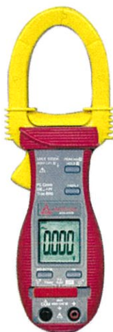
รูปที่ 4.23 เครื่องวัดกำลังไฟฟ้า
