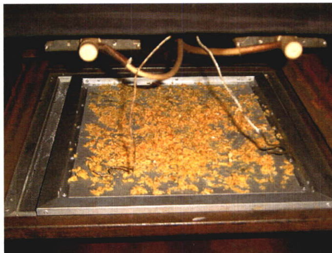
ภาพที่ 4.3 การอบกระเทียมในตู้อบรังสีอินฟราเรด
