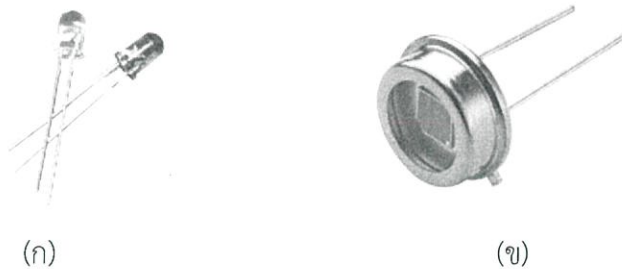
รูปที่ 2.6 แสดงชนิดของโฟโตไดโอด (ก) ตอบสนองต่อแสงในย่านอินฟราเรด (ข) ตอบสนองต่อแสงที่ตามองเห็นได้
