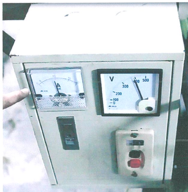
ภาพที่ 5.5 แสดงโวลต์และแอมป์มิเตอร์ขณะมีโหลดสูงสุด
