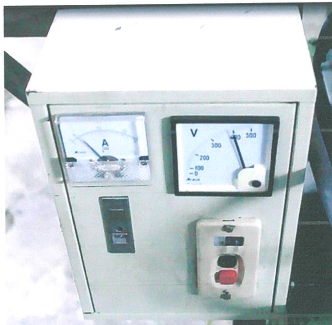
ภาพที่ 5.1 แสดงโวลต์และแอมป์มิเตอร์ขณะที่ยังไม่มีโหลด
