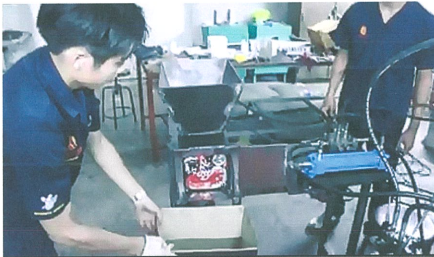
ภาพที่ 5.6 แสดงการโยกวาล์วคอนโทรลเพื่อดันกระบอกลูกสูบ B กลับ
