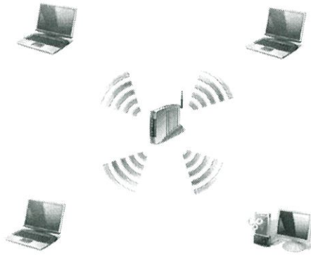
รูปที่ 2.19 ระบบ Wireless Lan แบบ Infrastructure [2]
