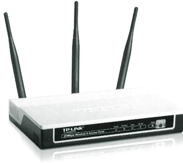
รูปที่ 2.21 Access point ที่มีการกระจายสัญญาณแบบ Multiple-Input Multiple-Output [3]
